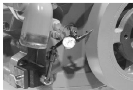
Проверка степени радиальной овализации
